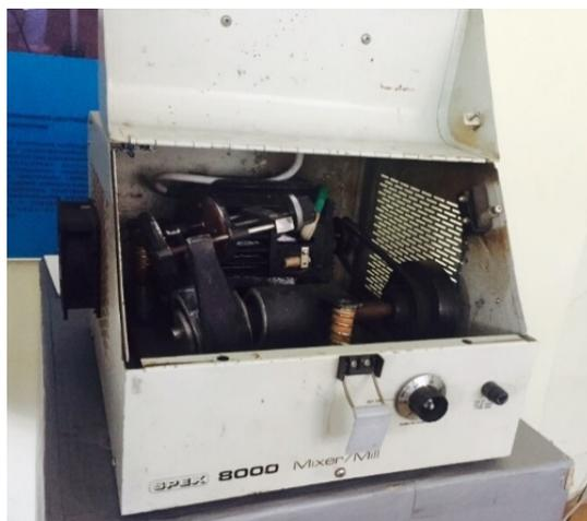
Рисунок 5 – Шаровая мельница «SPEX8000» с цилиндром и шариками из карбида вольфрама
